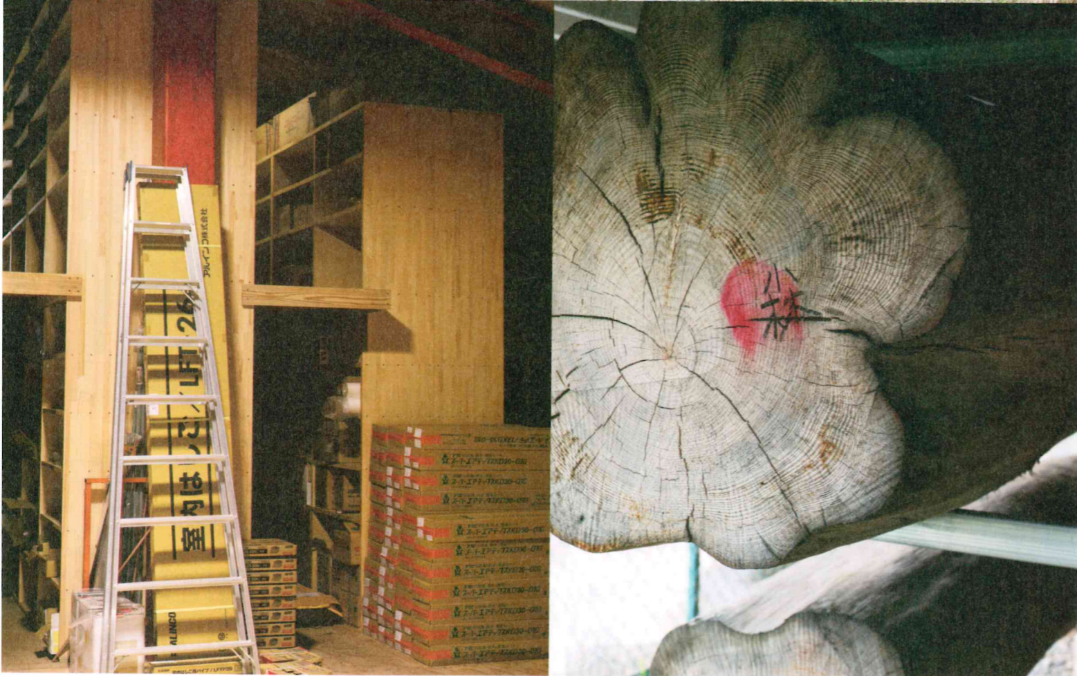
上・「あえて過酷な環境にさらしたほうがいい」と、おおらかに自然乾燥させる。8寸角のヒノキで7、8年。1寸太くなるごとに乾燥期間が1年延びる。右下・小林さんから予約が入った直径50cmの地松の梁材。左下・金物や塗料が並ぶ倉庫。在庫管理は仕入先任せで、適宜補充される。
